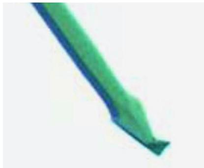
*Cantiléver observado con un microscopio óptico con un aumento de 1500 veces el tamaño real del cantiléver. Se puede observar la punta, que termina en un radio de curvatura de 7 nm, pero que en esta imagen no se puede distinguir ese radio de curvatura, para eso necesitamos una imagen de un microscopio FESEM (Field Emission Electron Beam Microscopy) con aumentos de 200 mil.*
